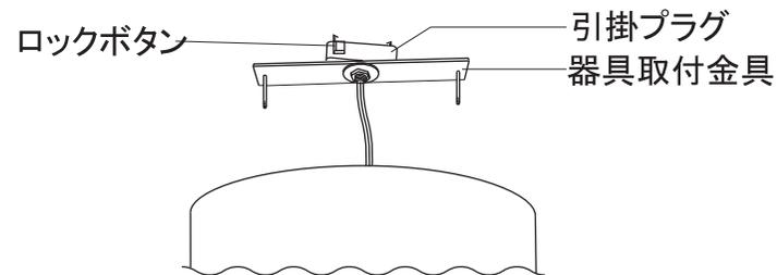
5. 器具本体をしっかり手で持ちながら、器具取付金具に付いている2本のビスに器具本体の2カ所のビス穴をあわせて、化粧ナット2本で確実に固定してください。
