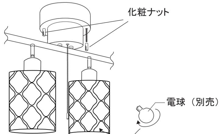
4. 器具本体をしっかり手で持ちながら、引っ掛けプラグを天井接続器に「カチッ」と音がするまで確実に回してください。
